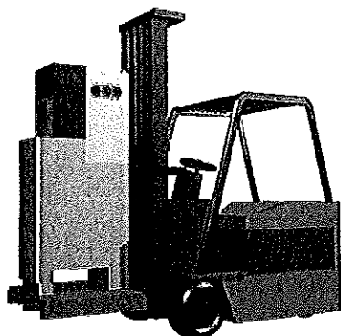
Фигура 2.2: Повдигане с мотокар на шкаф CGMCOSMOS
